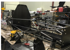
Figure 9 Jig 및 Frame 제작
