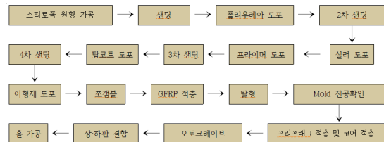
Figure 11 CFRP Monocoque Chassis 제작 공정도
