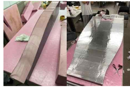
Fig. 8 undertray 몰드 제작 과정
