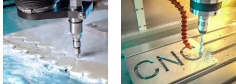
Photo. 1 워터젯 가공 Photo. 2 CNC 밀링 가공
