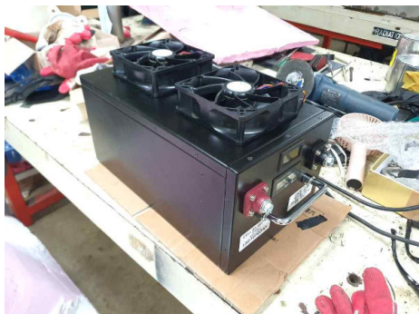
<Fig 40. 냉각팬을 배터리팩에 부착한 모습>
