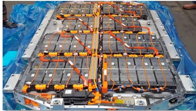
<아이오닉 5 배터리 팩에 장착된 버스바> 출처: 굿바이카 유튜브 영상
