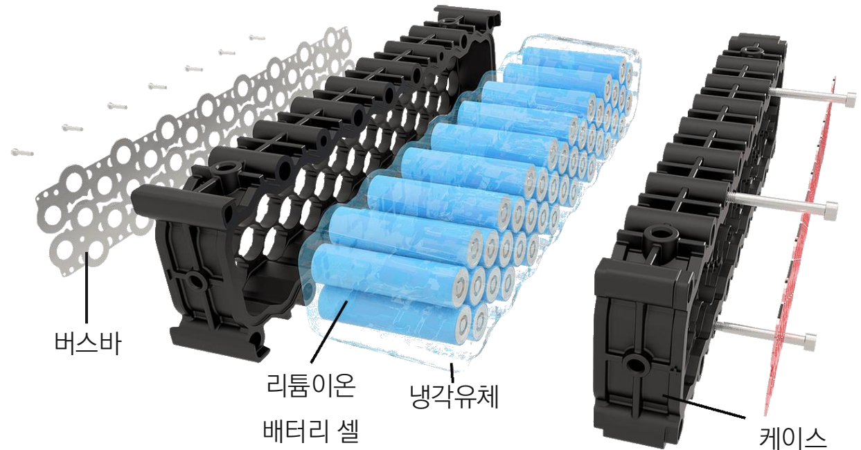
〈Xing mobility 사의 battery module 분해도〉
